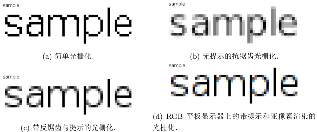
图 6.14: 使用不同算法的字体光栅化 (图源: 维基百科).
